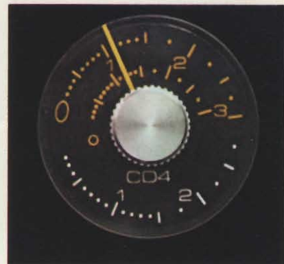
L'antiskating è calibrato diversamente per le puntine coniche, ellittiche e CD4.
